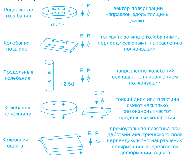
Рис. 1. Основные виды колебаний (E – направление электрического поля, P – направление поляризации)
